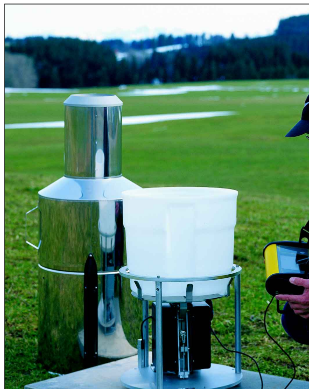
PLUVIO, 40 дюймов / 1000 мм, со сборником жидкости и кольцом для подогрева
