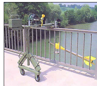
С31 с лебедкой на 25 кг и передвижной тележкой для измерений (например, для проведения измерений с моста).
