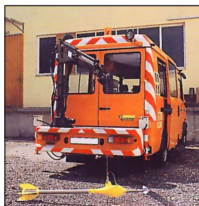
Измерительная лаборатория на грузовике - двухбарабанная лебедка фирмы ОТТ на 100 кг и измеритель скорости потока С31.
