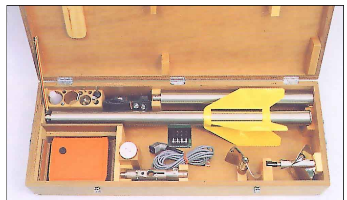
Рис.8: Инструментальный набор для С31 с подвесной кабельной системой, вес обтекателя (средняя часть) 25, 50 и 100 кг.
