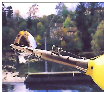
Кабельный подвесной измеритель скорости потока С31 на пружинном кабель-кране.
